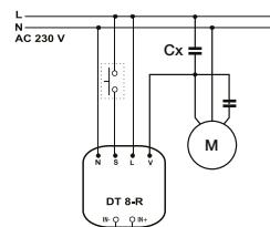
Cx – kapacitní předřadník, volbou jeho hodnoty se nastavují otáčky ventilátoru pro trvalé větrání, hodnota kondenzátoru nesmí být nižší než 2 µF
