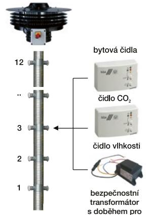
schéma zapojení trvalého a nárazového větrání pro CTB s časovým spínačem DT 8-R
