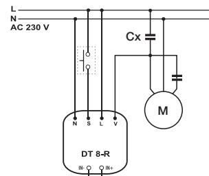
Cx – kapacitní předřadník, volbou jeho hodnoty se nastavují otáčky ventilátoru pro trvalé větrání, hodnota kondenzátoru nesmí být nižší než 2  $\mu$ F
